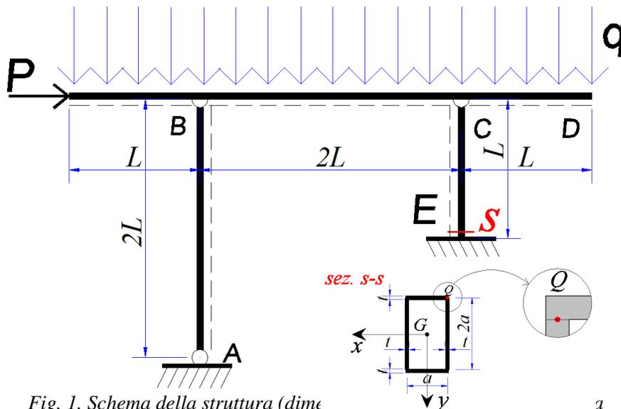
Fig. 1. Schema della struttura (dime sezione trasversale S
